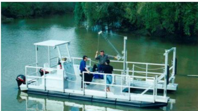
ဝန်ချိစက် ၊ ချိန်းဘလောက် ၊ ကရိန်းစသည့် ကိရိယာများတပ်ဆင်ထားသည့် လှုပ်ငန်းသုံး ရေယာဉ်အမျိုးအစားများ
